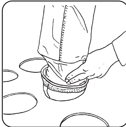
Bild 1. Monteringskragen monteras i hålet, varefter påsen förs genom monteringskragen. Först när påsen har kommit ner helt och hållet tas monteringskragen bort.
