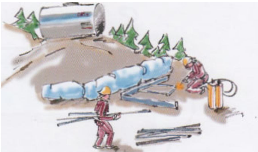
En temporär invallning är en metod för att förhindra att plötsliga läckage når fram till arbetsplatsen.
