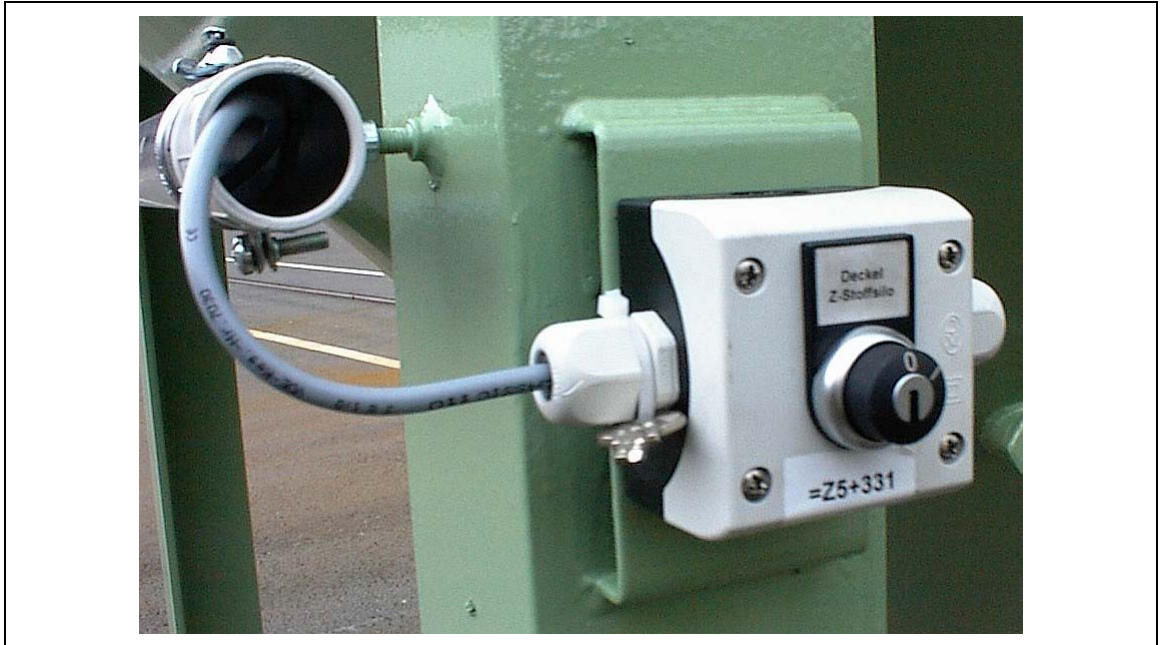
Eksempel på nøkkelbryter på forrådsbeholderen.
